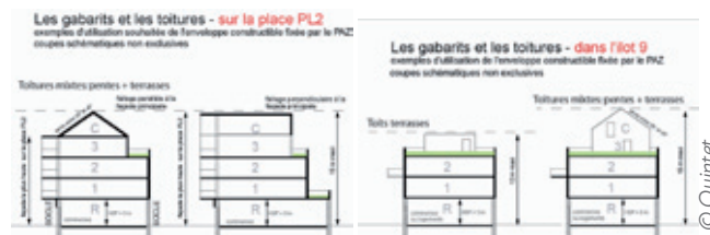
Coupes de principe - document du CPAUP : utiliser le gabarit maximal et surélever le rez-de-chaussée pour créer un socle
